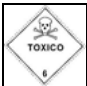
Rótulo peligro principal
